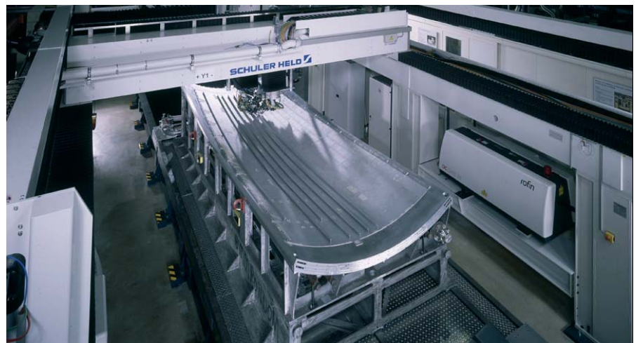
ABBILDUNG 1: Die erfolgreiche Inbetriebnahme der flexiblen XXL-Laserstrahlschweißanlage mit CNC-integrierter Doppel-3D-Nahtführung eröffnet dem Fraunhofer IWS Dresden neue Möglichkeiten zur Technologieentwicklung auf dem Gebiet des Laserstrahlschweißens für die Luft- und Raumfahrt. (Quelle: Schuler Held Lasertechnik)
