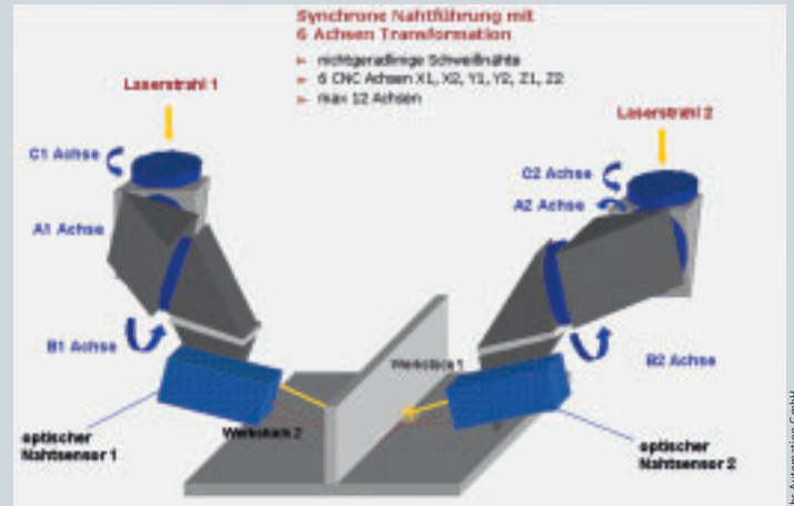
... oder als synchrone 3D-Nahtführung mit kinematischer 6-Achs-Transformation
